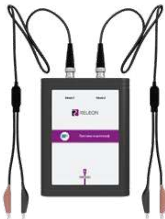
Рис. 1. Двухканальная приставка-осциллограф Releon
